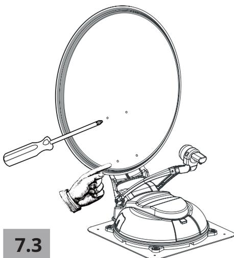
Vyjměte 4 šrouby s příslušnými přírubovými maticemi a talíř na talíř z balení a pomocí křížového šroubováku připevněte talíř k držáku talíře (viz obrázek 7.3). Znovu připojte anténu, pokud byla dříve odpojena, a poté ji zavřete
