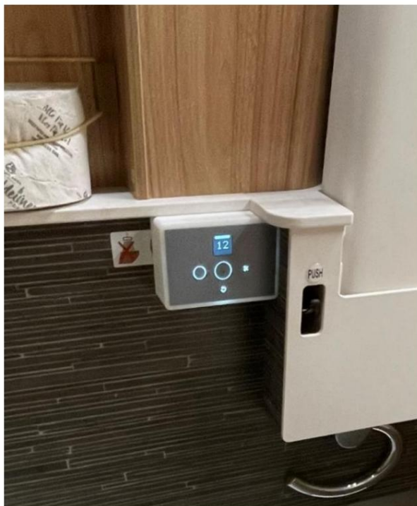
Displej C1 nainstalovaný pomocí krytu pro povrchovou montáž
