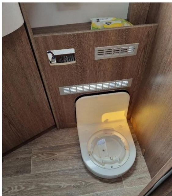
L-adaptér umístěn, servisní otvor zcela zakrytý
