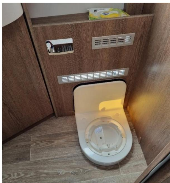
L adaptér umístěn, servisní otvor zcela zakrytý
